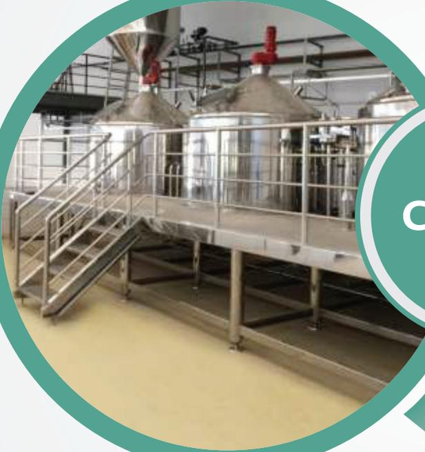
En esta área ocurre todo el proceso caliente de la elaboración de la cerveza: maceración, filtraje del macerado y hervor, este ambiente debe poseer alto control de contaminación siendo así el revestimiento debe ser impermeable y de fácil asepsia.
