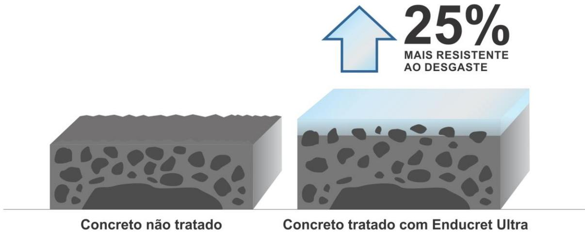
*Obs.: Ensaio realizado sobre corpo de prova de concreto (30 Mpa) sem a utilização de cura hidráulica ou química, os resultados obtidos acima são o máximo valor alcançado em ensaios que utilizam como parâmetros as Normas vigentes ou internas, realizado em laboratório em condições ideais.*
